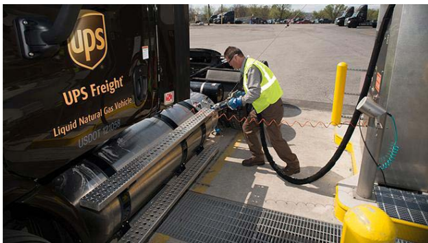
Figure 4 - Camion de livraison UPS en station de chargement de GNL
