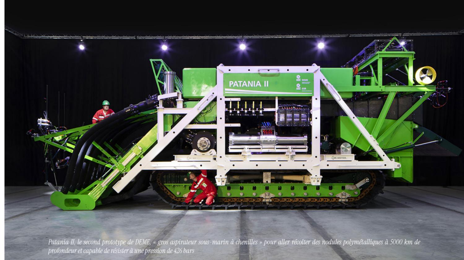
Patania II, le second prototype de DEME, « gros aspirateur sous-marin à chenilles » pour aller récolter des nodules polymétalliques à 5000 km de profondeur et capable de résister à une pression de 426 bars
